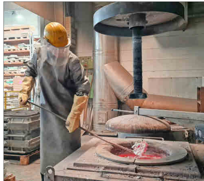
Flüssiges Aluminium wird aus dem Elektro-Schmelzofen geschöpft.
